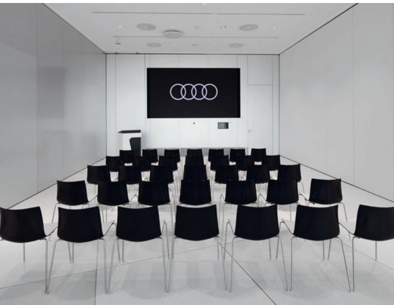
Dieser Raum ist mit einer 3,6 m x 2 m großen LED-Wand ausgestattet, die über eine UHD-Auflösung mit 3840 x 2160 Pixeln verfügt und über Bodentanks, kabellos (ClickShare) oder mit Inhalten aus der Regie bespielt werden kann.
