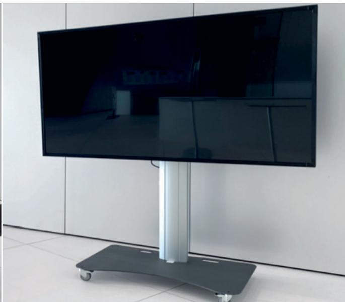
Die Videobar von Bose ist eine ausgezeichnete Audio- und Video-Lösung für hybride Veranstaltungen (z. B. Teams). Der 84-Zoll-Monitor auf der höhenverstellbaren Stele wird per HDMI angesteuert und mit ClickShare kabellos mit der Videotechnik des Konferenzraums verbunden.
